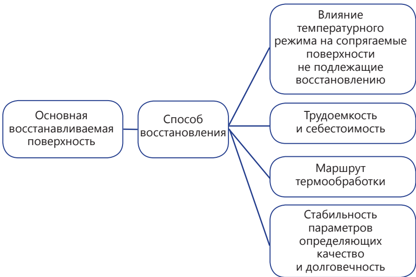
Система «конструкция-способ восстановления» [2]
