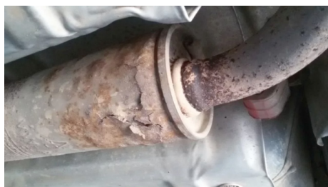
Рис. 1. Трещины в результате коррозии
