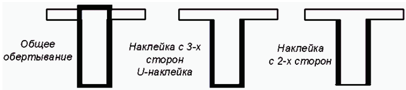
Рис. 1. Схемы наклейки ВКМ при усилении наклонных сечений
