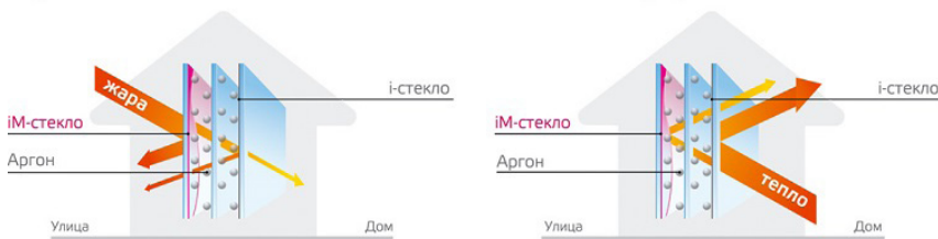
Рис. 4. Свойства мультифункционального стекла
